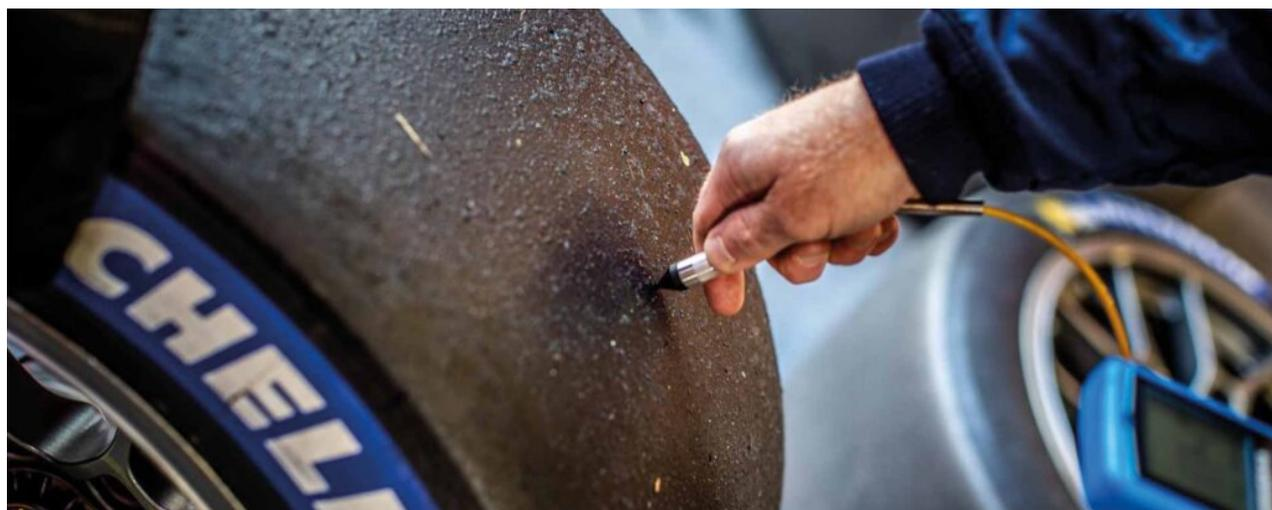
Partiamo con il presupposto che gli pneumatici progettati per il Motorsport sono studiati per lavorare a temperature che vanno dagli 80°C ai 120°C.
