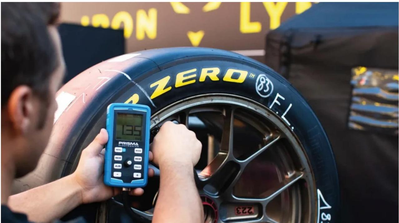
E' dunque fondamentale nel Motorsport utilizzare gli pneumatici nel corretto range di temperatura per ottenere il massimo rendimento e la minor degradazione possibile.
