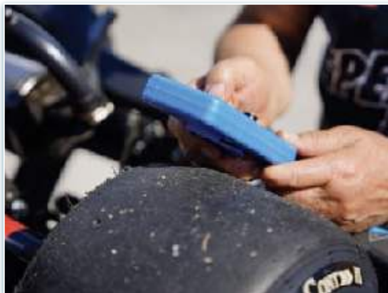
Misura con Sensore Infrarosso.
