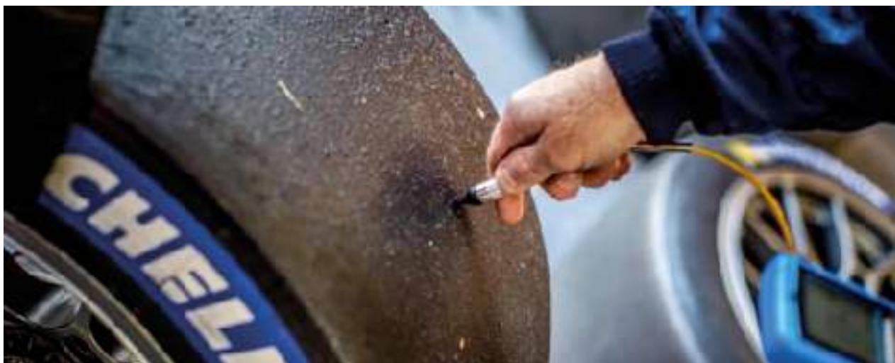
[ Medición con sonda de aguja ]
