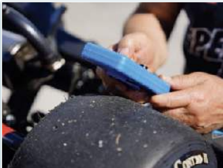
[ Medición con sensor infrarrojo ]
