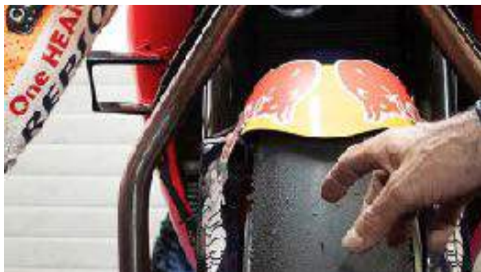
[ Ejemplo de graining en un neumático de moto ]
